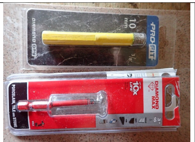
Diamantbohrer 5 mm für Loch Diamantbohrer 10 mm für Absenkung des Schraubenkopfes (mehrere Bohrungen pro Loch)
